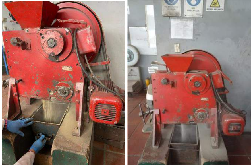
Fotografía 20. Conminución de las muestras mediante trituración para reducir tamaño y facilitar su homogeneización y análisis.
