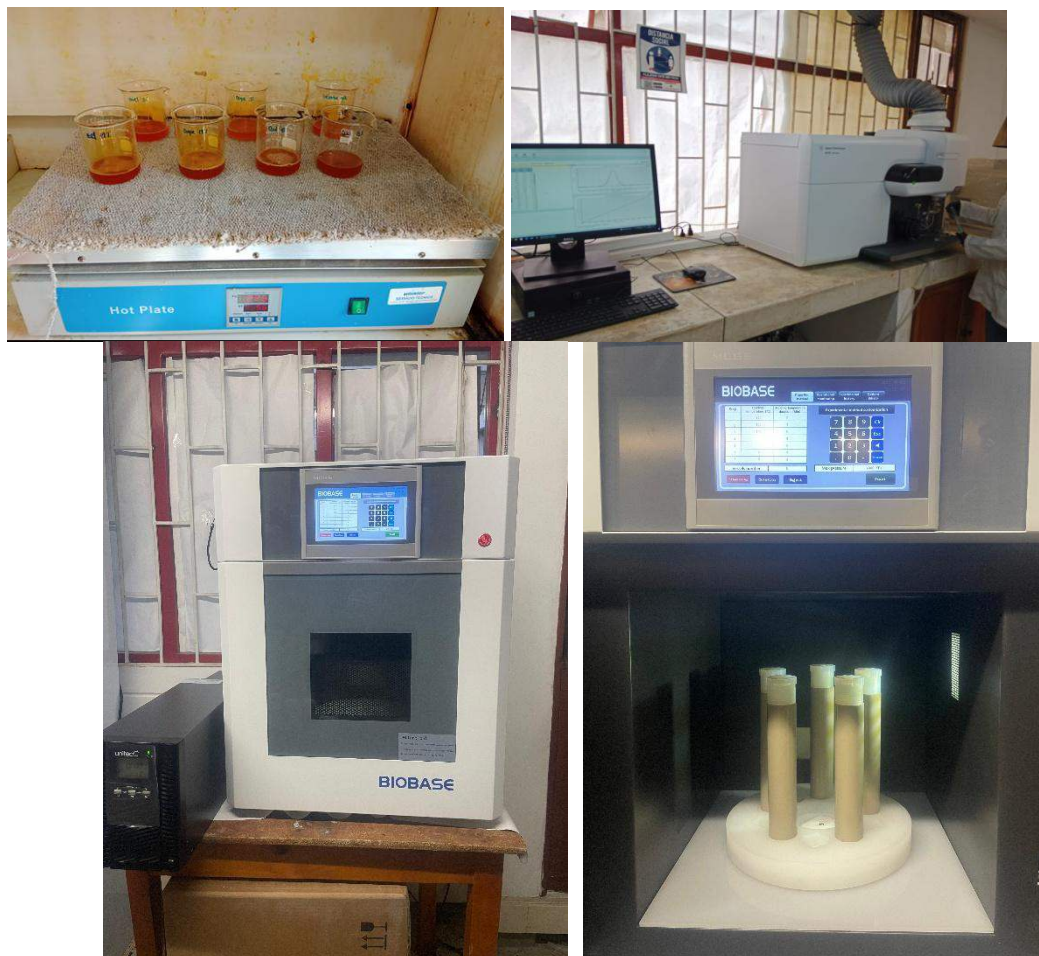
Fotografía 22. Caracterización química mediante MP-AES para determinar concentración elemental con alta precisión y sensibilidad.
