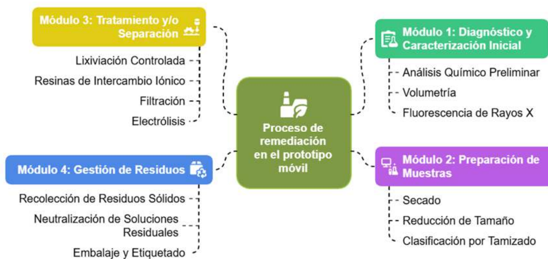
Figura 47. Proceso de remediación propuesto por el equipo técnico de la UPTC e implementado en el prototipo móvil
