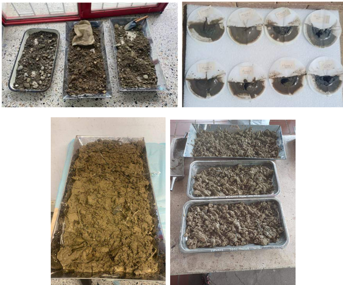
Fotografía 19. Secado de muestras a temperatura ambiente para eliminar humedad sin alterar las fases minerales presentes.
